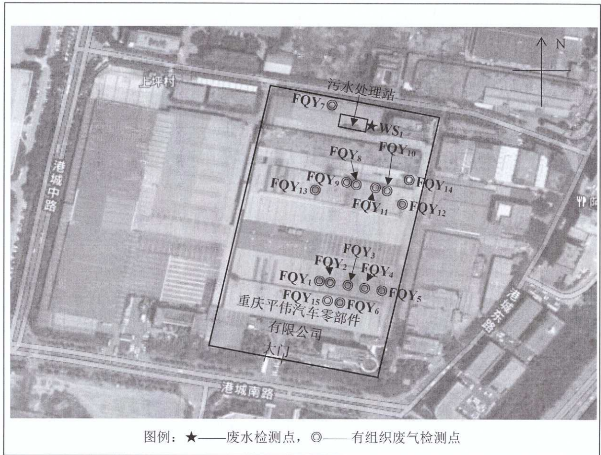
图 1 废水和有组织废气检测布点示意图
