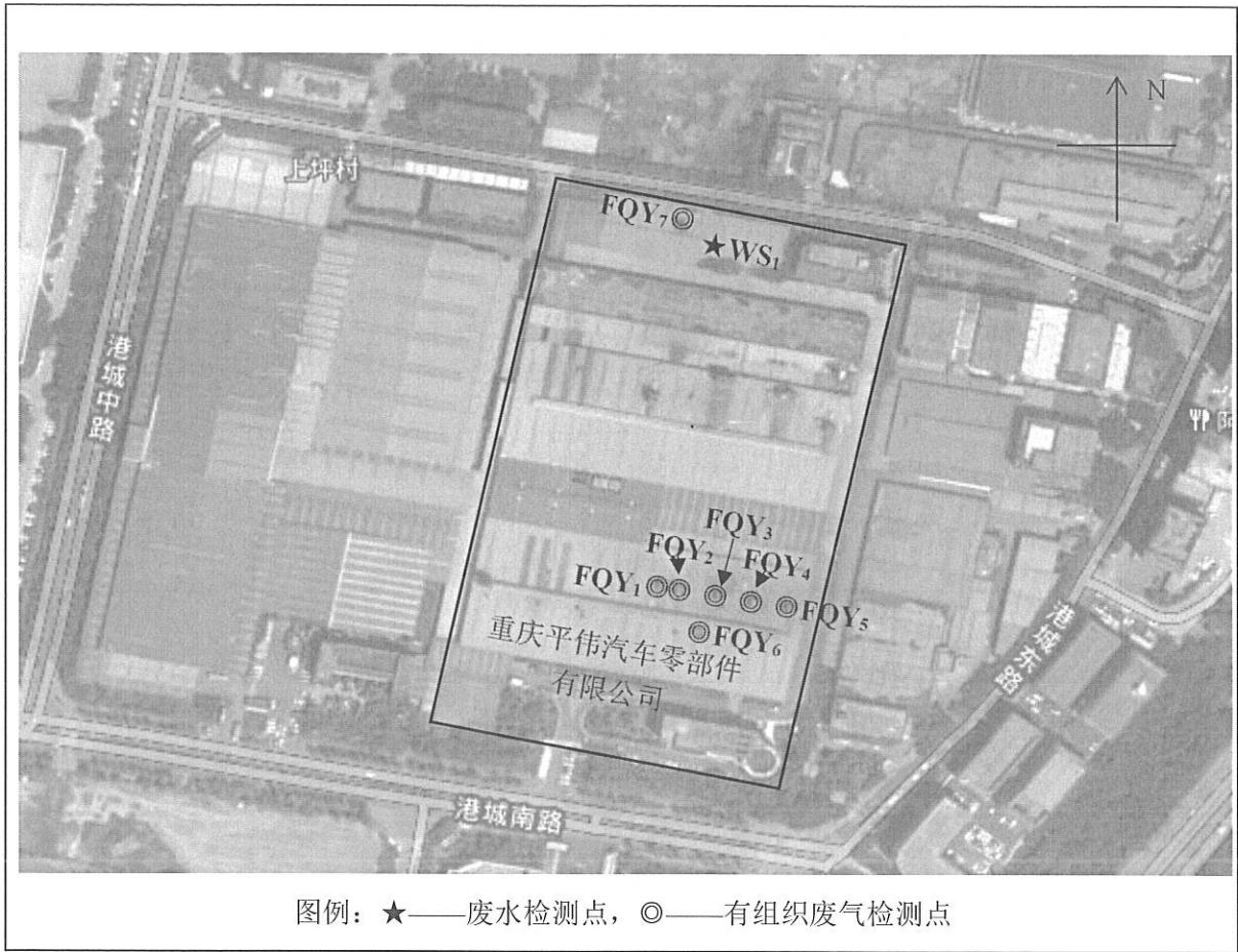
图1 废水和有组织废气检测布点示意图
